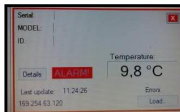
En cliquant sur "Details" il est possible de visualiser le type d'alarme durant l'état d'alerte
