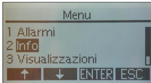
Utilisez les touches fléchées pour sélectionner le menu souhaité et confirmez-le avec ENTER, les paramètres sont affichés, s'ils sont présents dans le menu sélectionné. Utilisez les touches fléchées pour sélectionner le paramètre souhaité et le confirmer avec ENTER, la valeur du paramètre clignote ; toujours avec les touches fléchées il est possible de modifier ; en confirmant avec ENTER la donnée redevient fixe.
